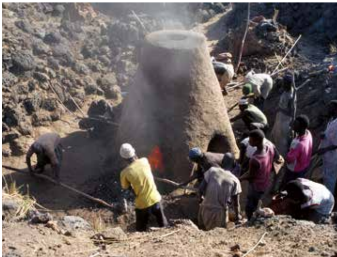
Reconstitution d'une réduction du fer. Les forgerons sortent l'éponge de fer du four à l'aide de grandes perches. Après épuration, ils en travaillent les morceaux à la forge pour en faire des outils agricoles, des ustensiles, des armes et des parures (photo E. Huysecom).
